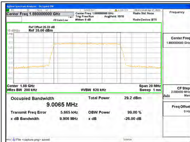
Band2 / 10MHz / QPSK/ Mid CH
