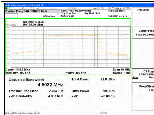
Band5 / 5MHz / QPSK / High CH
