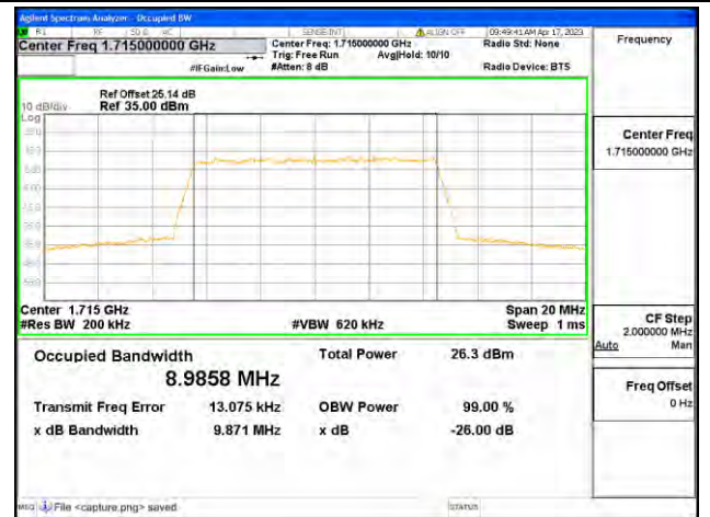
Band4 / 10MHz / 64QAM / Low CH
