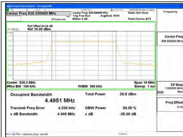
Band5 / 5MHz / QPSK/ Low CH
