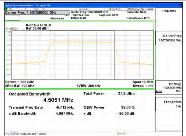
Band2 / 5MHz / 16QAM / High CH
