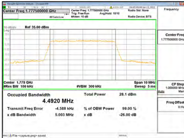
Band66 / 10MHz / Low CH / 16QAM
