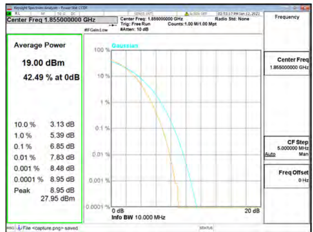
Band2 / 10MHz / Low CH / 64QAM
