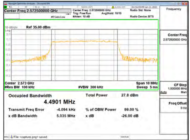
Band38 / 5MHz / Mid CH / QPSK
