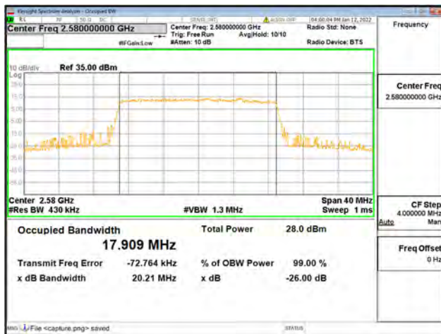
Band38 / 20MHz / Low CH / 16QAM
