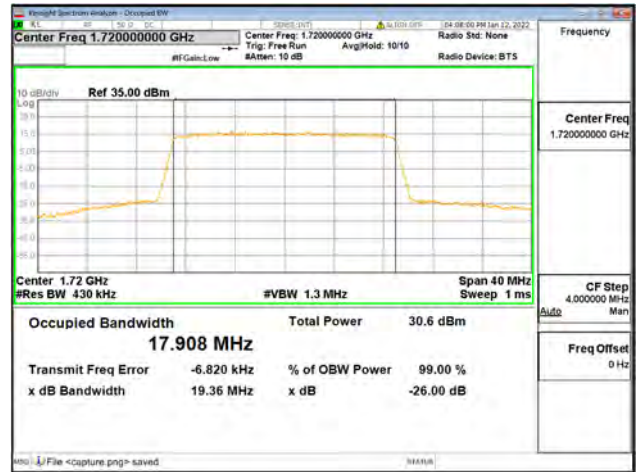
Band66 / 20MHz / Low CH / 64QAM
