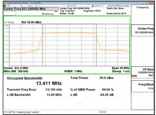
Band26 / 15MHz / Mid CH / QPSK
