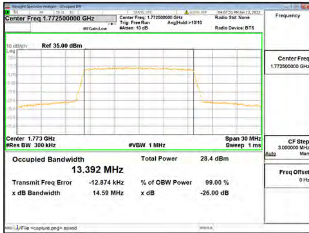
Band66 / 20MHz / Low CH / 16QAM
