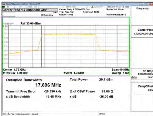
Band66 / 20MHz / Low CH / 16QAM
