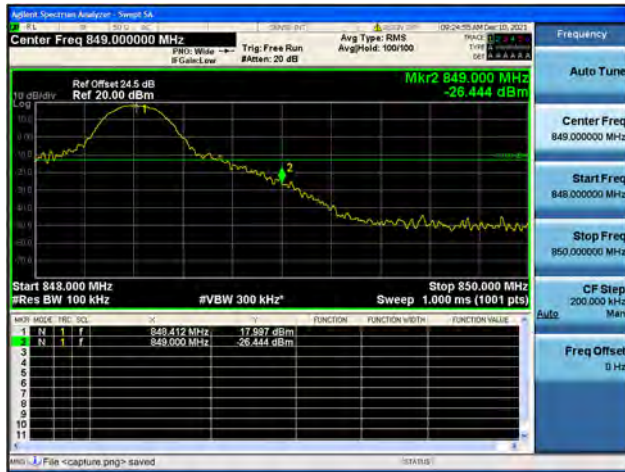
Band5 / 10MHz / High CH / QPSK / 1 RB
