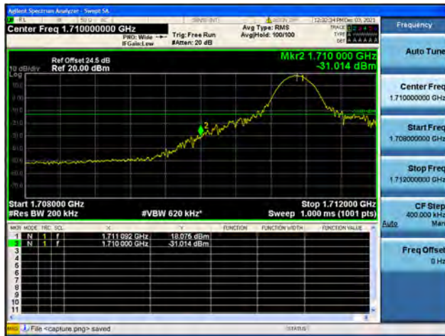
Band4 / 20MHz / High CH / QPSK / 1 RB
