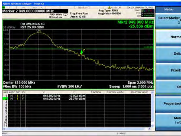
Band26 / 10MHz / High CH / QPSK / 1 RB
