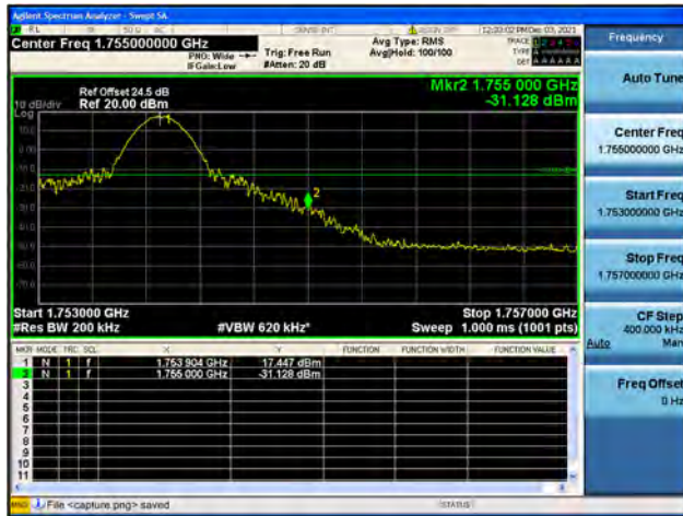
Band4 / 20MHz / High CH / QPSK / 1 RB
