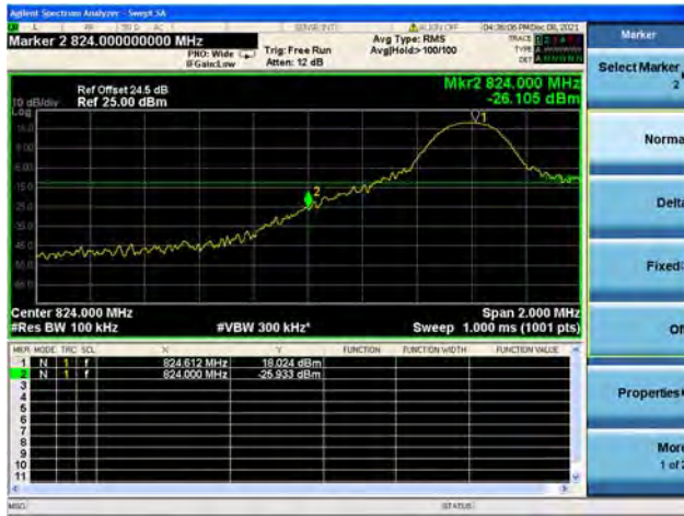
Band26 / 10MHz / High CH / QPSK / 1 RB
