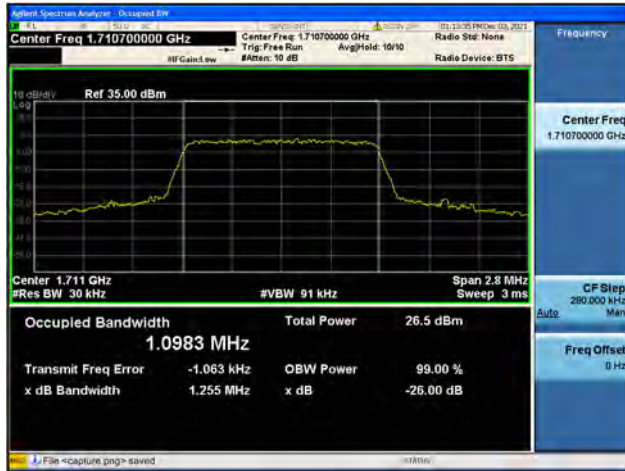
Band4 / 1.4MHz / Low CH / 64QAM
