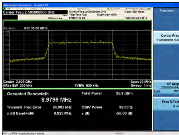
Band7 / 10MHz / Low CH / 16QAM
