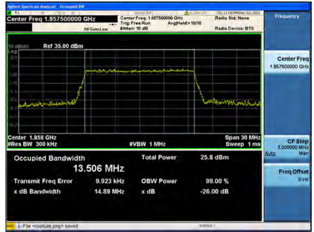
Band2 / 15MHz / Mid CH / QPSK
