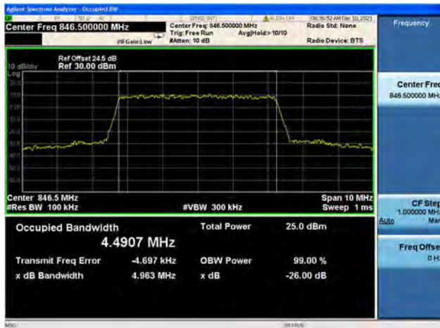
Band26 / 10MHz / Low CH / 16QAM
