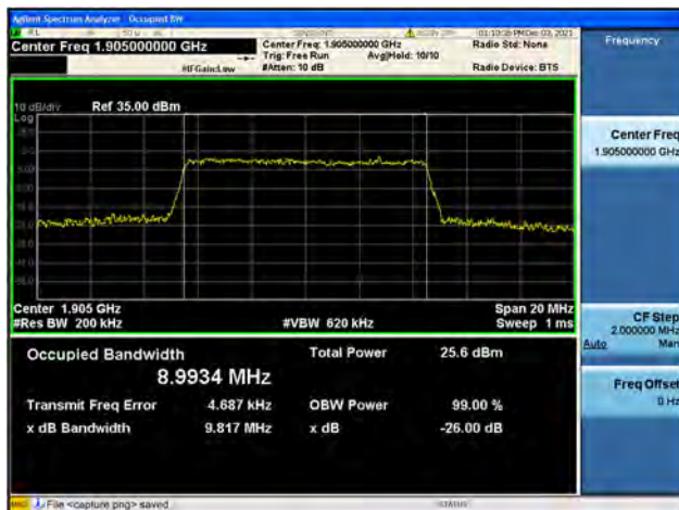
Band2 / 10MHz / High CH / 16QAM
