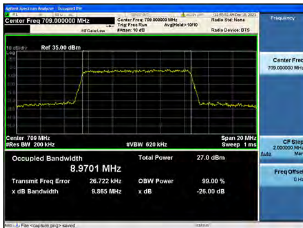
Band17 / 10MHz / Low CH / 16QAM
