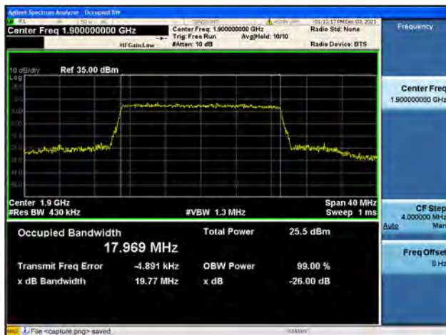
Band2 / 20MHz / High CH / 16QAM
