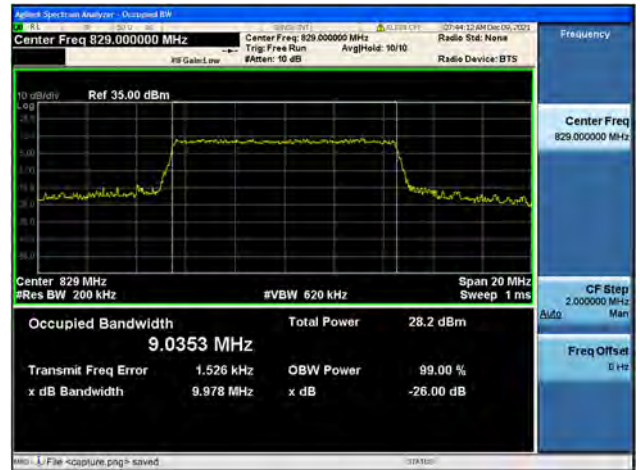
Band5 / 10MHz / Low CH / 64QAM
