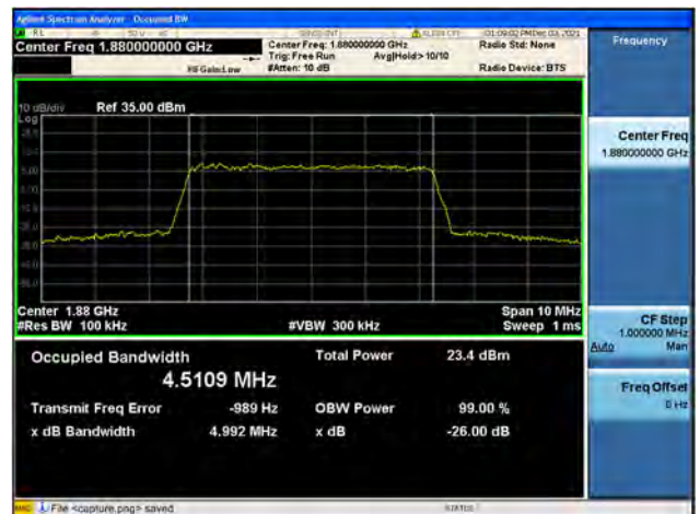
Band2 / 5MHz / Mid CH / 64QAM
