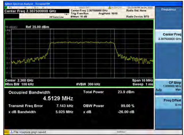
Band40/ Block A / 5MHz / Mid CH / QPSK
