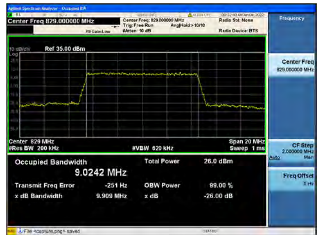
Band5 / 10MHz / Low CH / 64QAM
