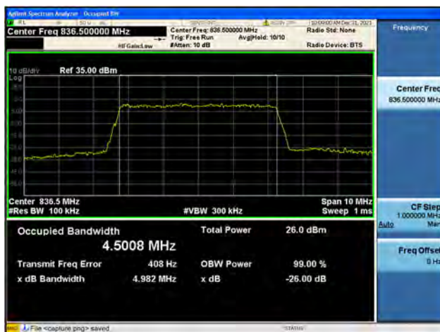
Band26 / 5MHz / Mid CH / 16QAM
