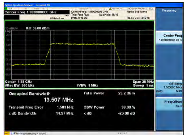
Band2 / 15MHz / Mid CH / 64QAM
