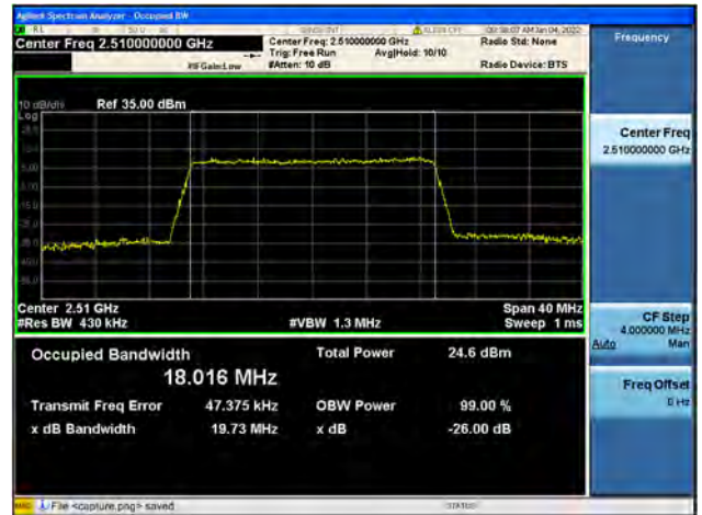
Band7 / 20MHz / Low CH / 64QAM
