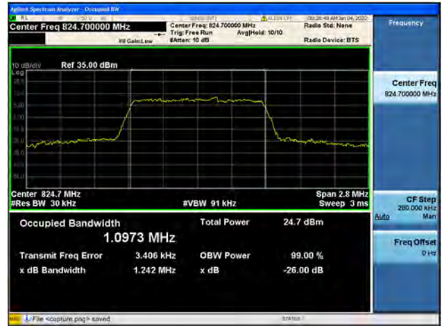
Band5 / 1.4MHz / Mid CH / QPSK
