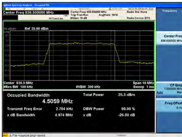
Band5 / 5MHz / Mid CH / 16QAM
