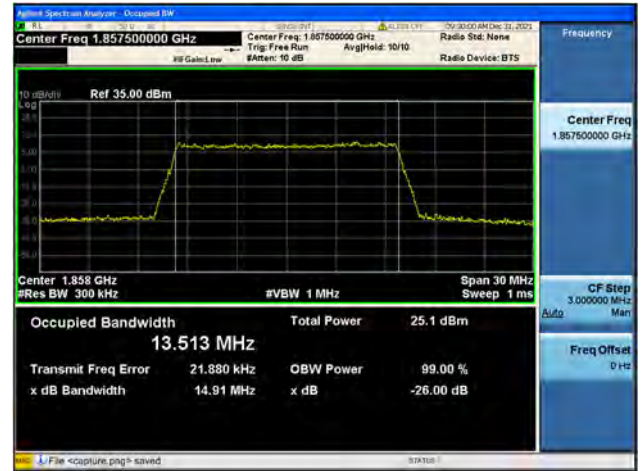
Band2 / 15MHz / Mid CH / QPSK
