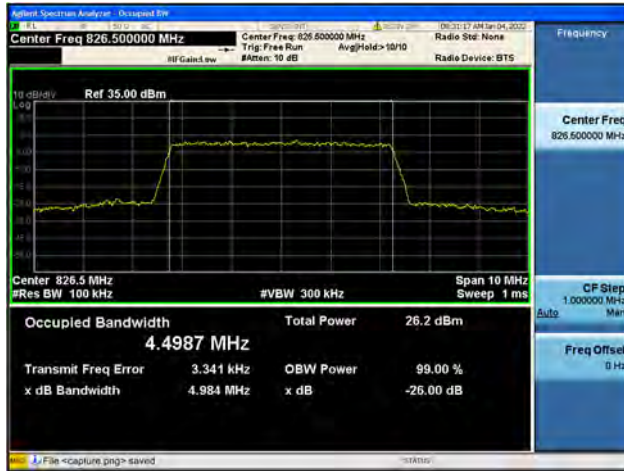
Band5 / 5MHz / Low CH / 64QAM
