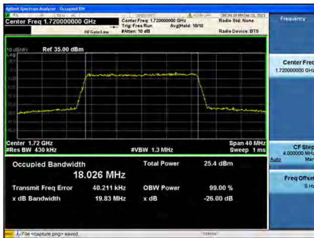
Band4 / 20MHz / Low CH / 16QAM
