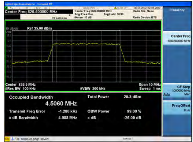
Band5 / 5MHz / Mid CH / QPSK
