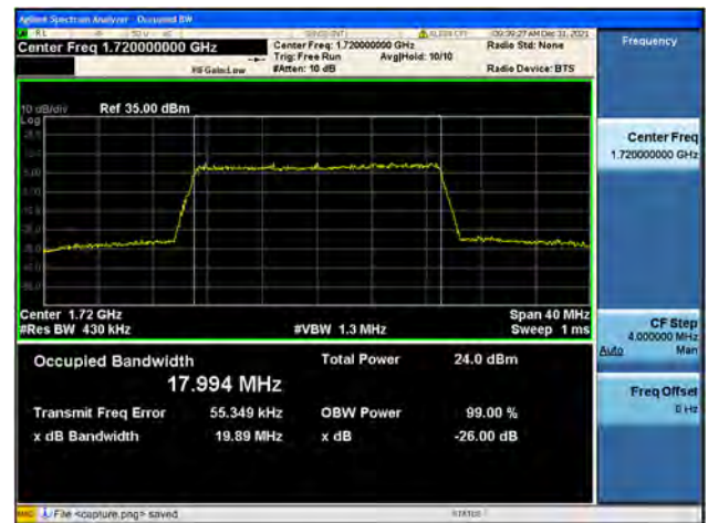
Band4 / 20MHz / Low CH / 64QAM
