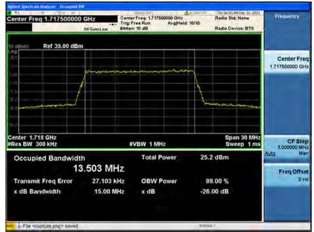
Band4 / 15MHz / Mid CH / QPSK
