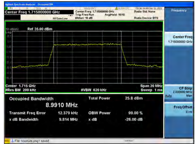
Band4 / 10MHz / Low CH / 64QAM
