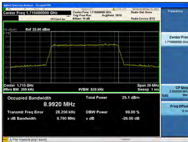
Band4 / 10MHz / Low CH / 16QAM
