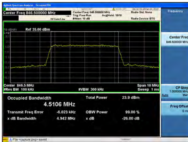
Band5 / 10MHz / Low CH / 16QAM
