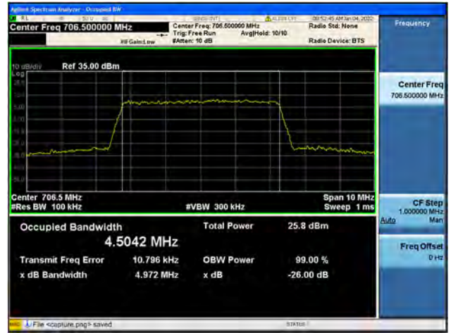
Band17 / 5MHz / Mid CH / QPSK
