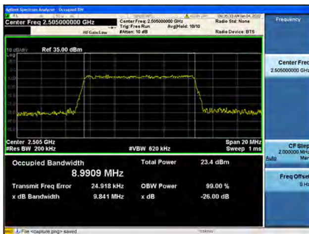
Band7 / 10MHz / Low CH / 16QAM
