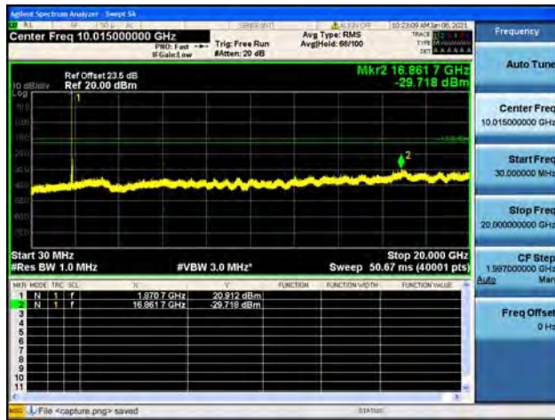
Band2 / 20MHz / Mid CH / 64QAM
