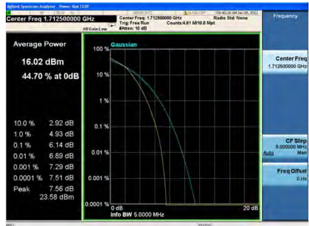
Band66 / 5MHz / Mid CH / QPSK
