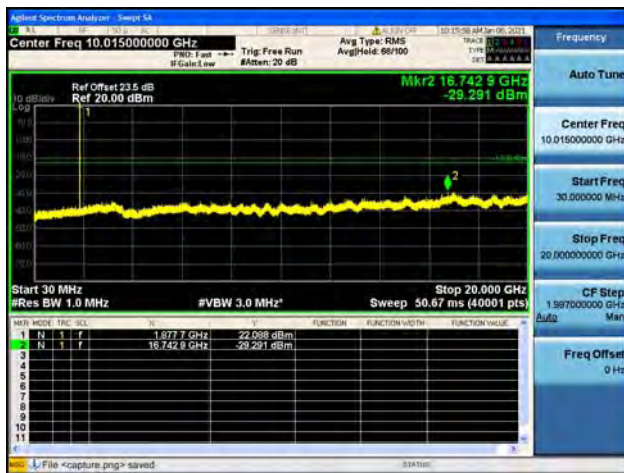
Band2 / 5MHz / Mid CH / 16QAM
