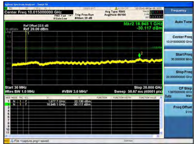
Band2 / 5MHz / Mid CH / 64QAM
