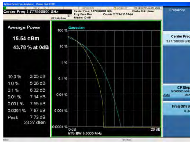
Band66 / 10MHz / Low CH / 16QAM
