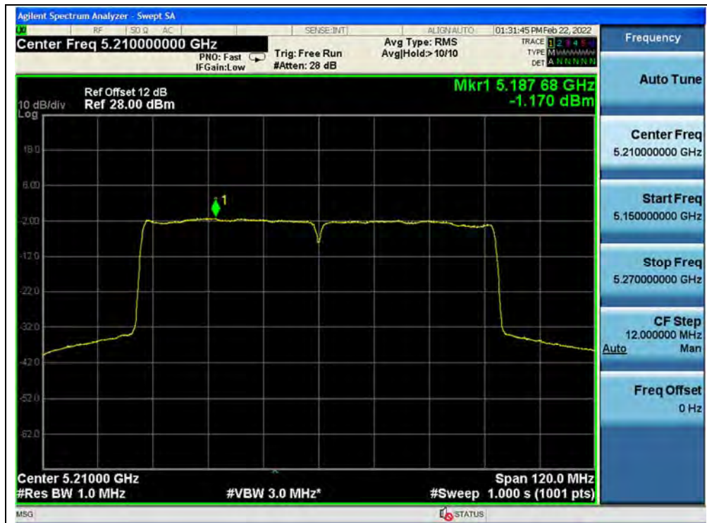
(Channel 42, 5210MHz, 802.11ac (VHT80))
