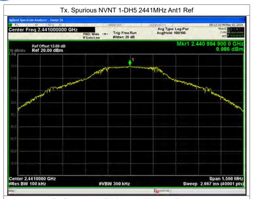
Tx. Spurious NVNT 1-DH5 2441MHz Ant1 Emission
