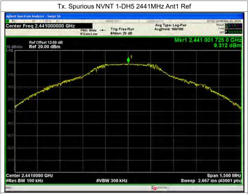
Tx. Spurious NVNT 1-DH5 2441MHz Ant1 Emission
