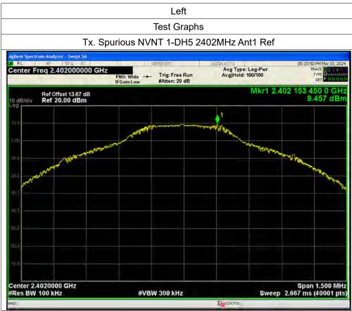
Tx. Spurious NVNT 1-DH5 2402MHz Ant1 Emission
