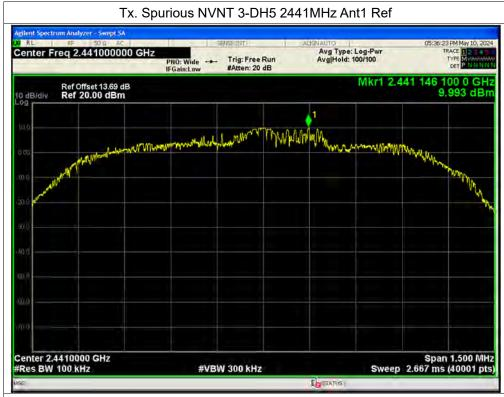
Tx. Spurious NVNT 3-DH5 2441MHz Ant1 Emission
