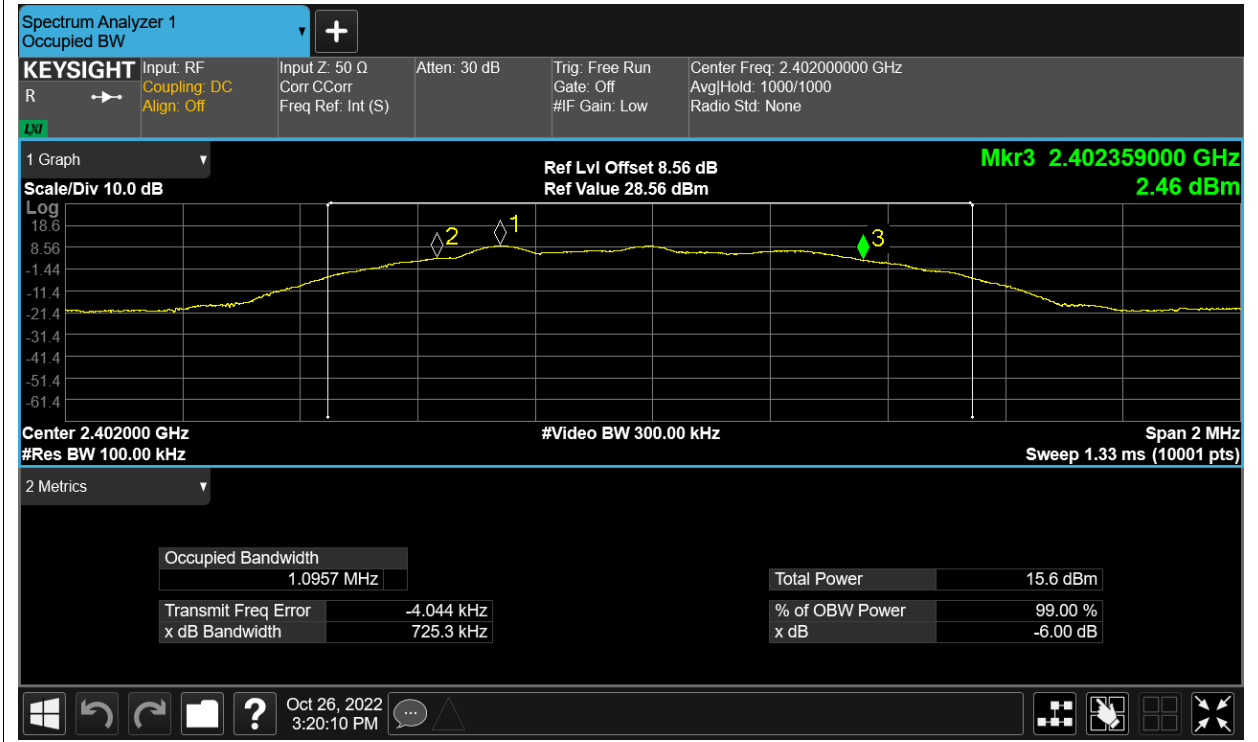
-6dB Bandwidth NVNT BLE 2442MHz Ant1
