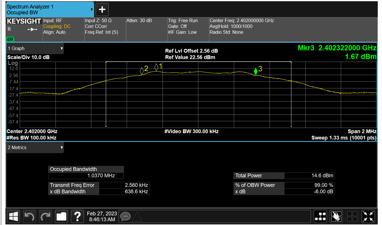
-6dB Bandwidth NVNT BLE 2442MHz Ant1
