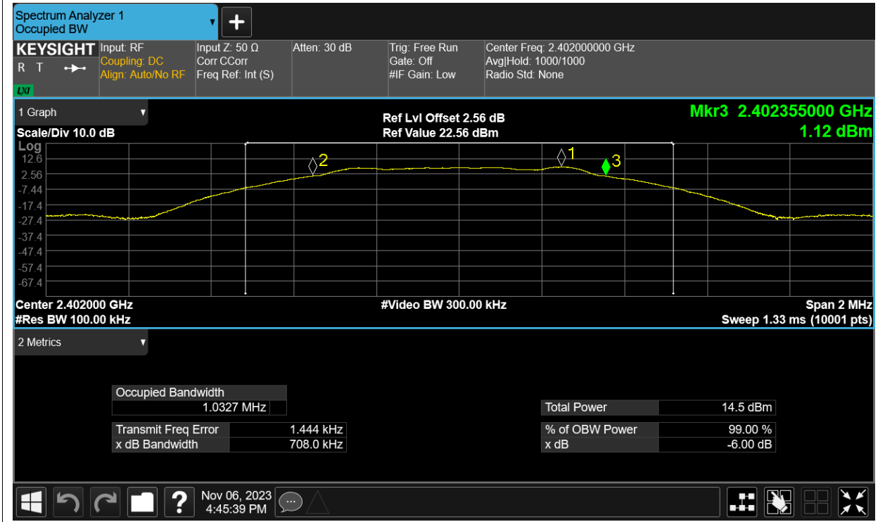
-6dB Bandwidth NVNT BLE 2442MHz Ant1
