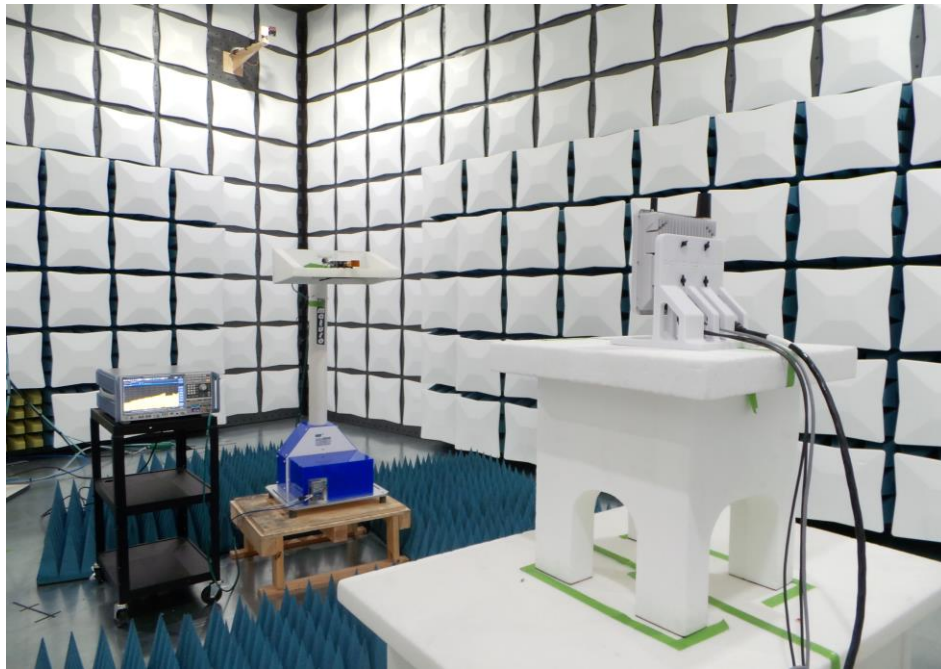
Setup 8. Test Setup >40GHz - DU
