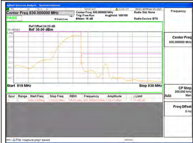
Band18 part90 / 5MHz / High CH / QPSK / 1 RB
