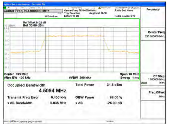
Band14 / 5MHz / QPSK/ Mid CH
