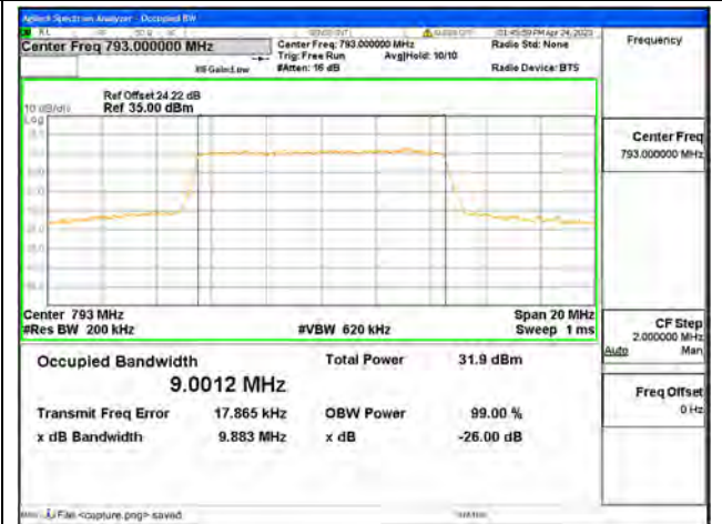
Band14 / 10MHz / QPSK/ Mid CH
