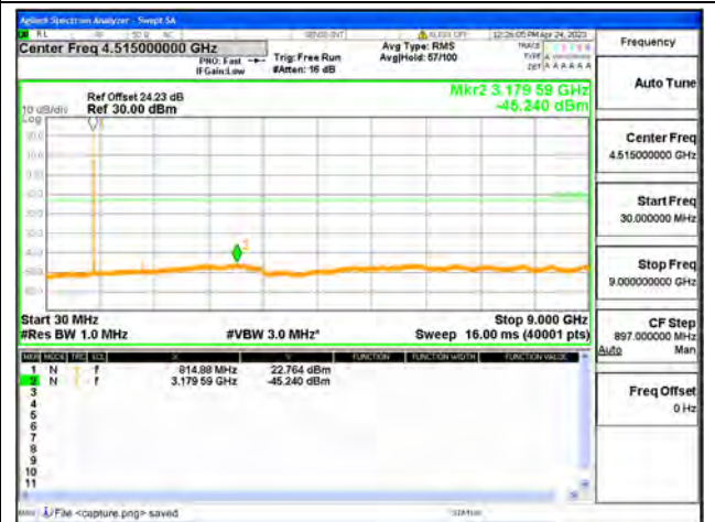
Band26 Part90 / 10MHz / Mid CH / QPSK
