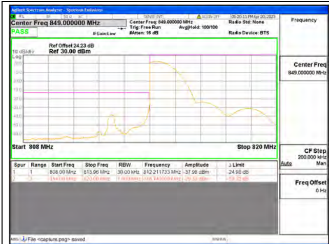
Band26 Part90 / 5MHz / Low CH / QPSK / 1 RB
