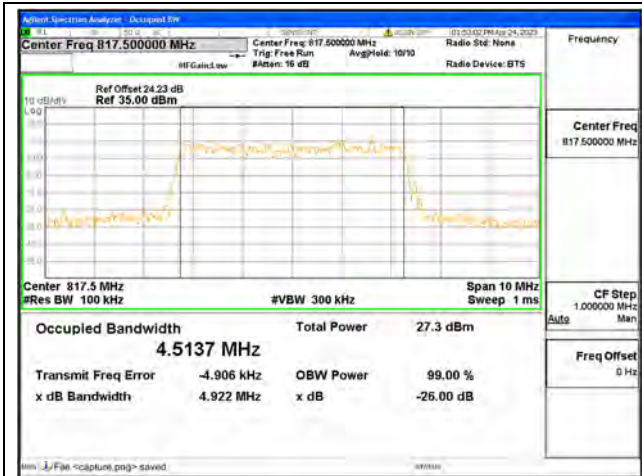
Band18 part90 / 5MHz / QPSK/ Low CH
