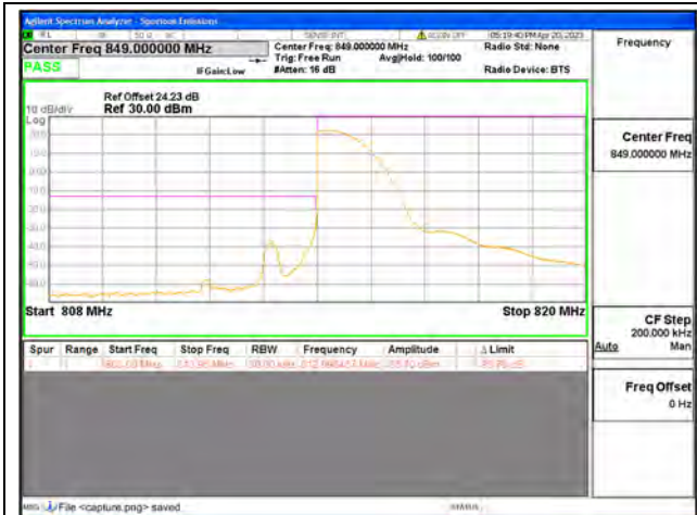
Band26 Part90 / 3MHz / Low CH / QPSK / 1 RB
