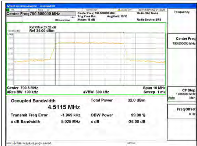
Band14 / 5MHz / QPSK/ Low CH
