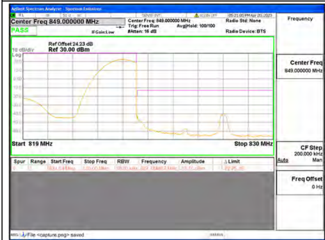
Band26 Part90 / 10MHz / High CH / QPSK / 1 RB
