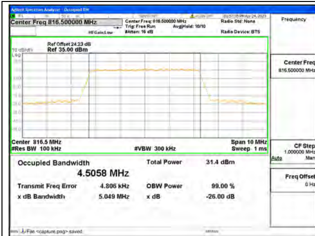
Band26 Part90 / 5MHz / QPSK/ Low CH
