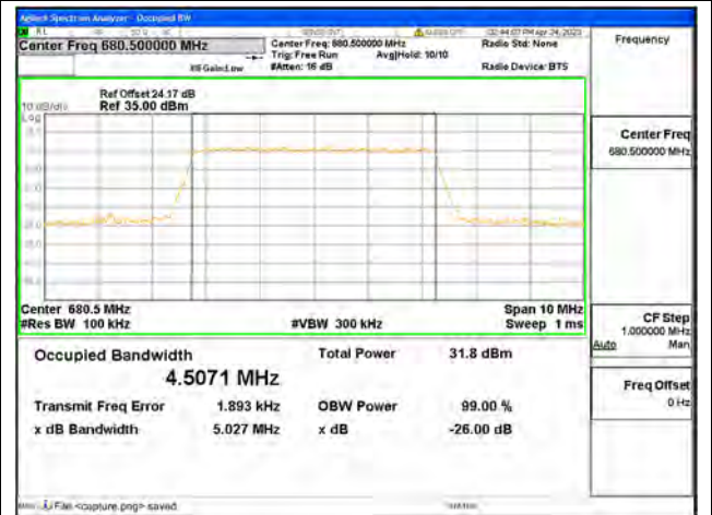
Band71 / 5MHz / QPSK/ Mid CH
