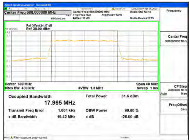
Band71 / 20MHz / QPSK/ High CH
