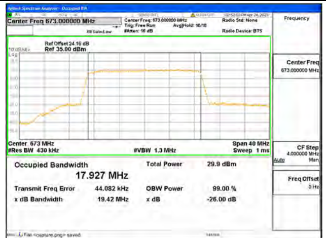
Band71 / 20MHz / 64QAM/ Low CH
