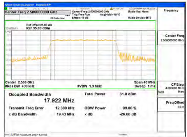
Band41 / 20MHz / QPSK/ Low CH
