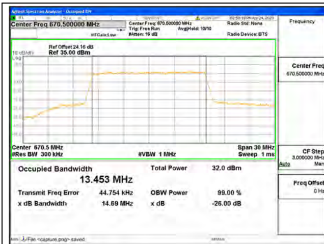
Band71 / 15MHz / QPSK/ Low CH
