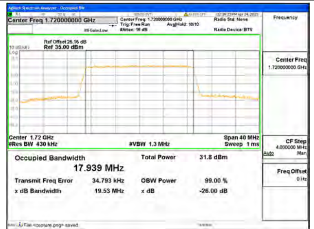
Band66 / 20MHz / QPSK/ Low CH
