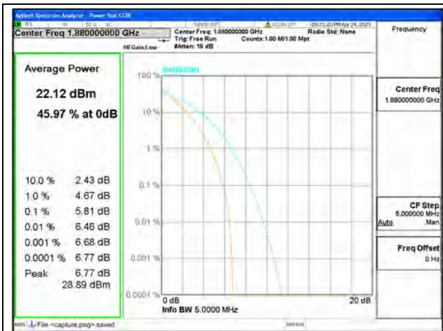
Band2 / 3MHz / Mid CH / QPSK
