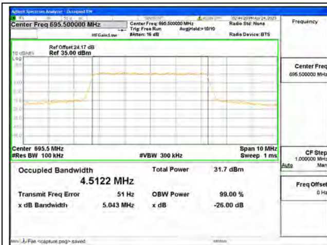
Band71 / 5MHz / QPSK/ High CH
