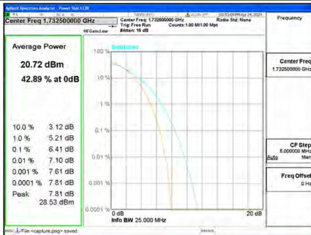
Band4 / 20MHz / Mid CH / 64QAM
