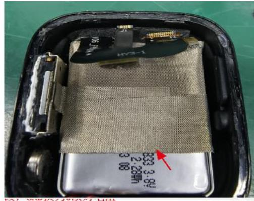
屏贴导电布屏蔽，屏蔽罩上贴长条形导电海绵，电池中间报导电布间包裹导电布，装配好电池后再贴导电布与喇叭接地
