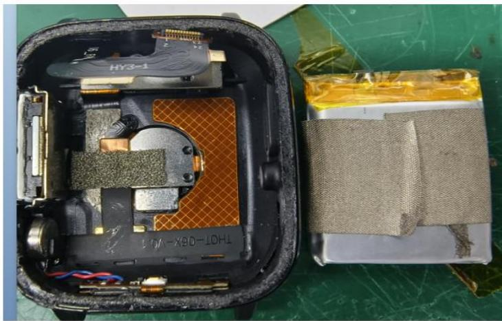
延长地和处贴导电泡棉与电池接通，且与心率金属片接通
