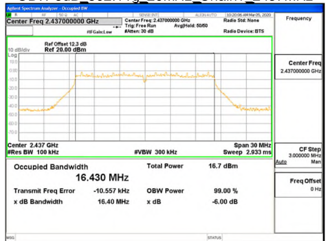
OBW 6dB 802.11g 20MHz Chain1 2462MHz
