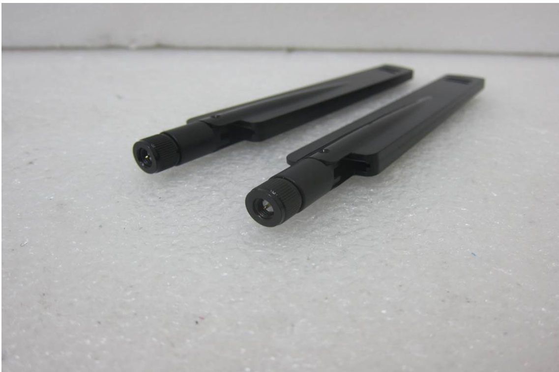
EUT 13 LTE Antenna
