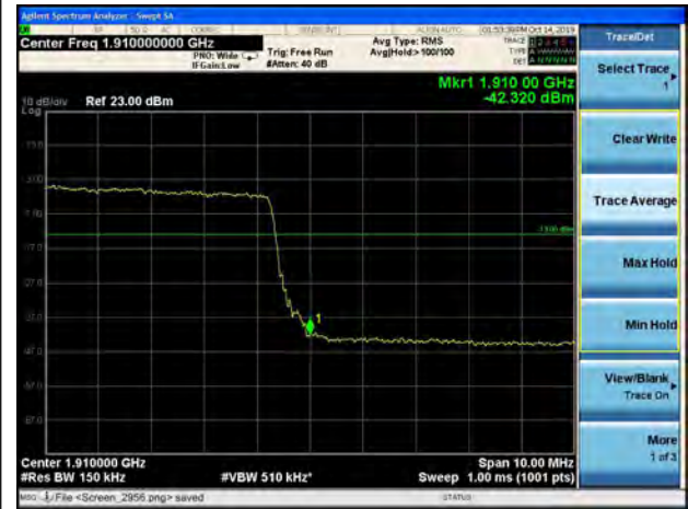
LTE Band 2 20MHz QPSK 1RB CH-High
