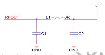
设计天线匹配网络距离模块不要超过5mm,走线控制50欧姆阻抗且需预留 π 型天线匹配网络。 **PCB布局时模块应尽量远离干扰源。**
