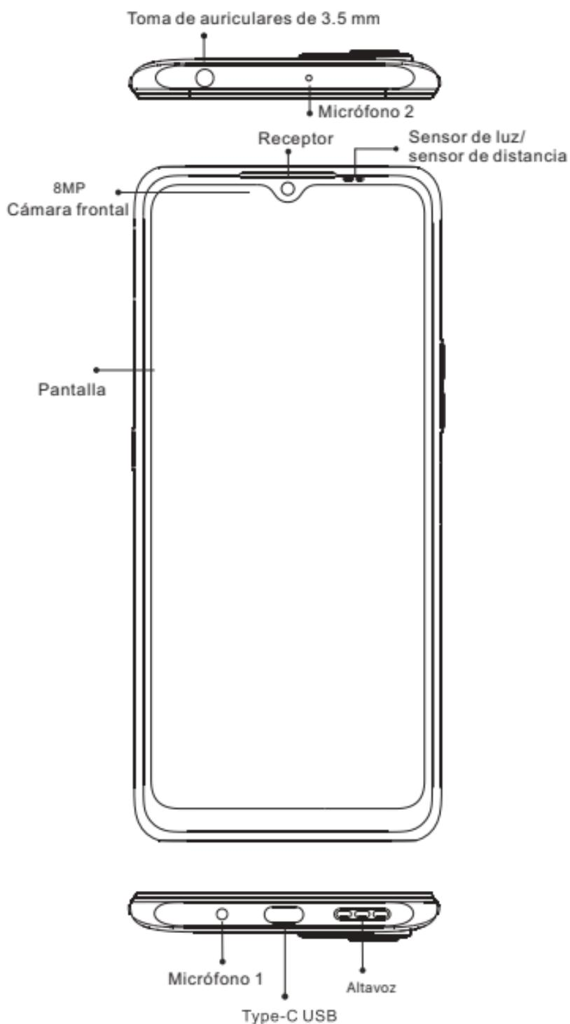
**Botón de encendido:** Pulse el botón de forma prolongada para activar el terminal. Mediante pulsación corta podrá encender y apagar la pantalla.
