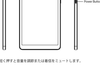
**音量キー:** 短く押すと音量を調節または着信をミュートします。
