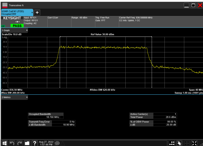
DC_2A_n5A_10MHz|20MHz_15kHz_1880MHz|836.5MHz_QP SK|DFT-s-OFDM QPSK_RB1@50|RB100@0
