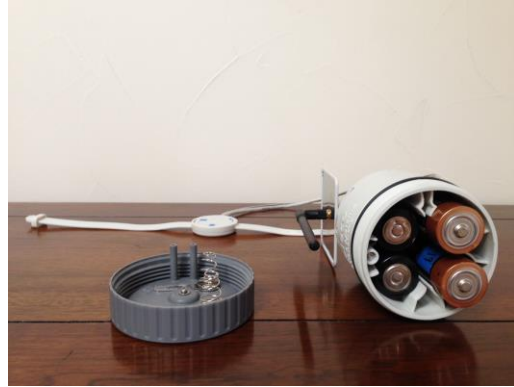
Fig. 3b: SU Battery Enclosure open
