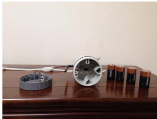
Fig. 3d: SU Battery Enclosure open
