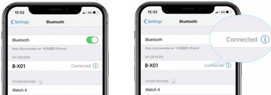
2. 手动配对：在双耳关机状态下，同时长按两个耳机的多功能键2秒给耳机开机，保持左耳和右耳的距离在10CM以内，左右耳机会在10秒内自动配对。再打开手机蓝牙，搜索到耳机的名称后点击连接，完成配对。
