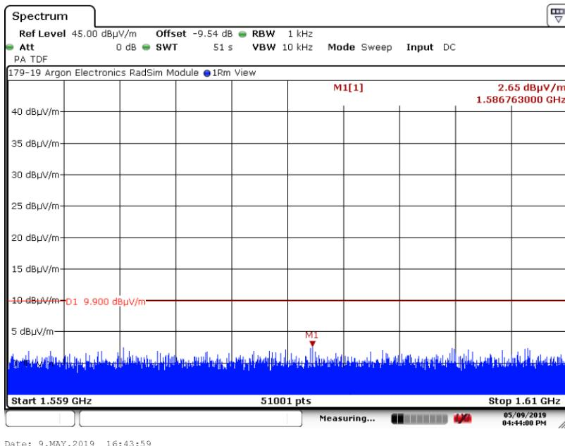
**6. Measurement Data (continued)****6.6. RMS Power in a 1 MHz Bandwidth (15.250 (d) (1), RSS-220 5.3.1 (d))**
