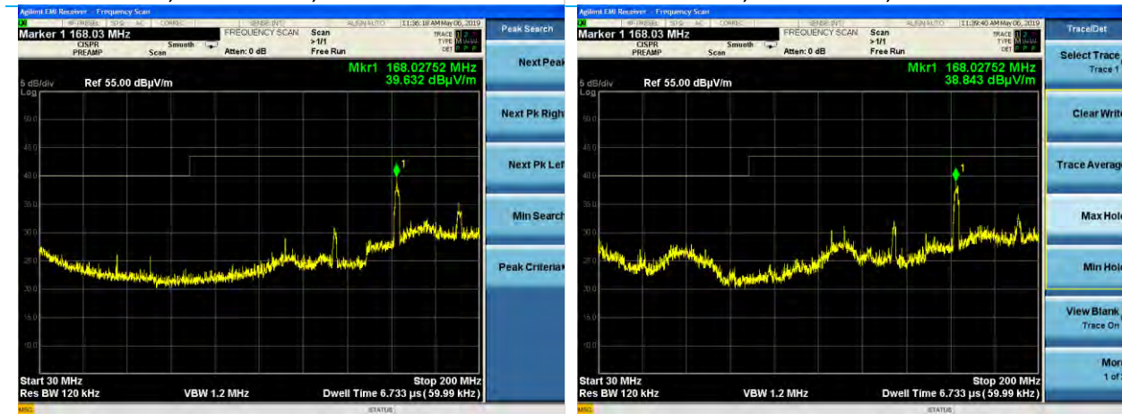
30-200 MHz, EUT Horizontal, Antenna Horizontal
