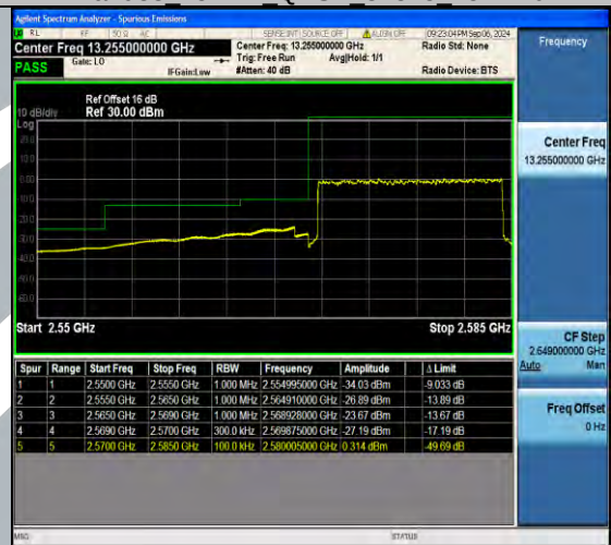
Band38 15MHz QPSK 38175 1RB#74
