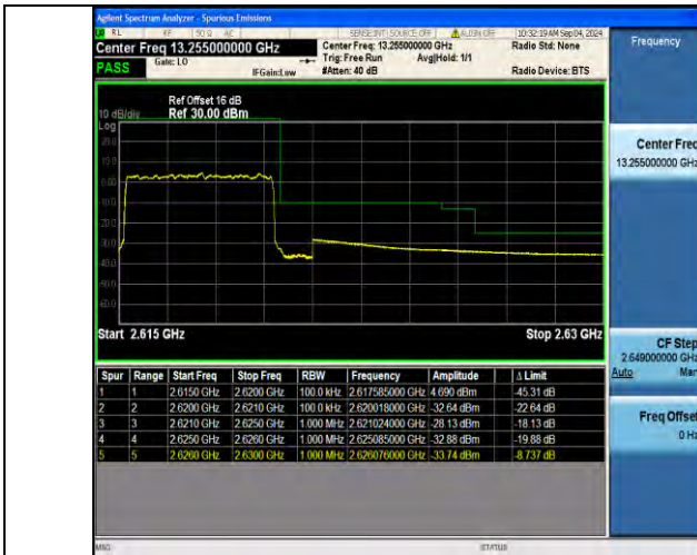
Band38 10MHz QPSK 37800 1RB#49
