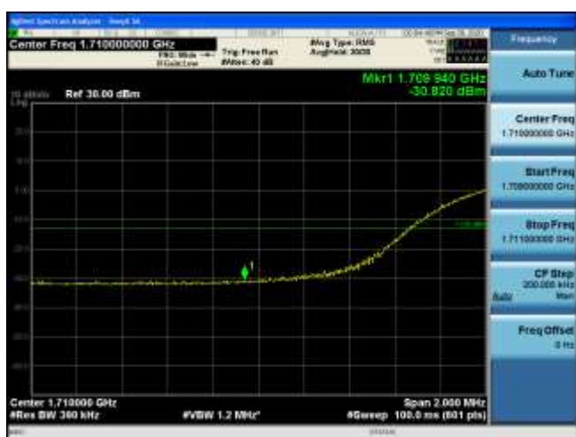
Low Band edge RB Size 100, RB offset 0
