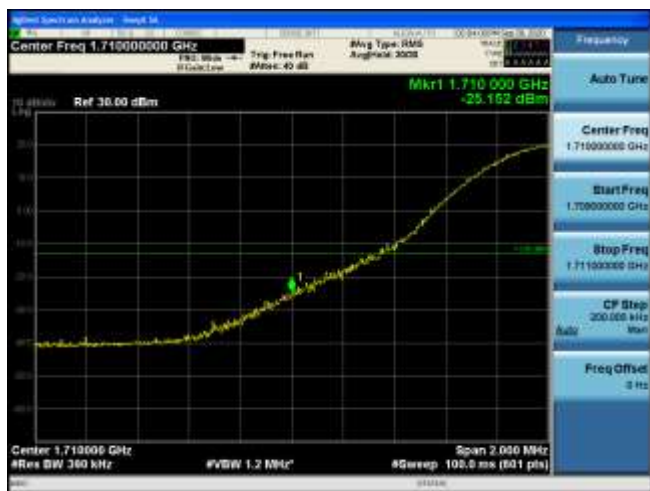
Low Band edge RB Size 100, RB offset 0
