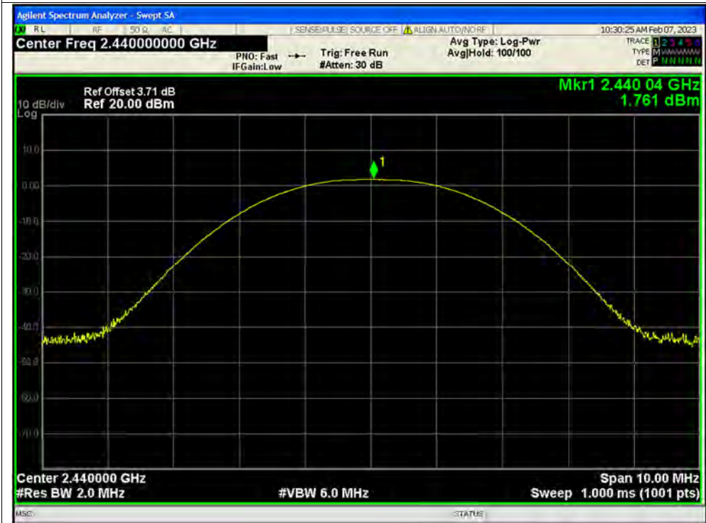
Peak Power NVNT BLE 1M 2440MHz Ant1
