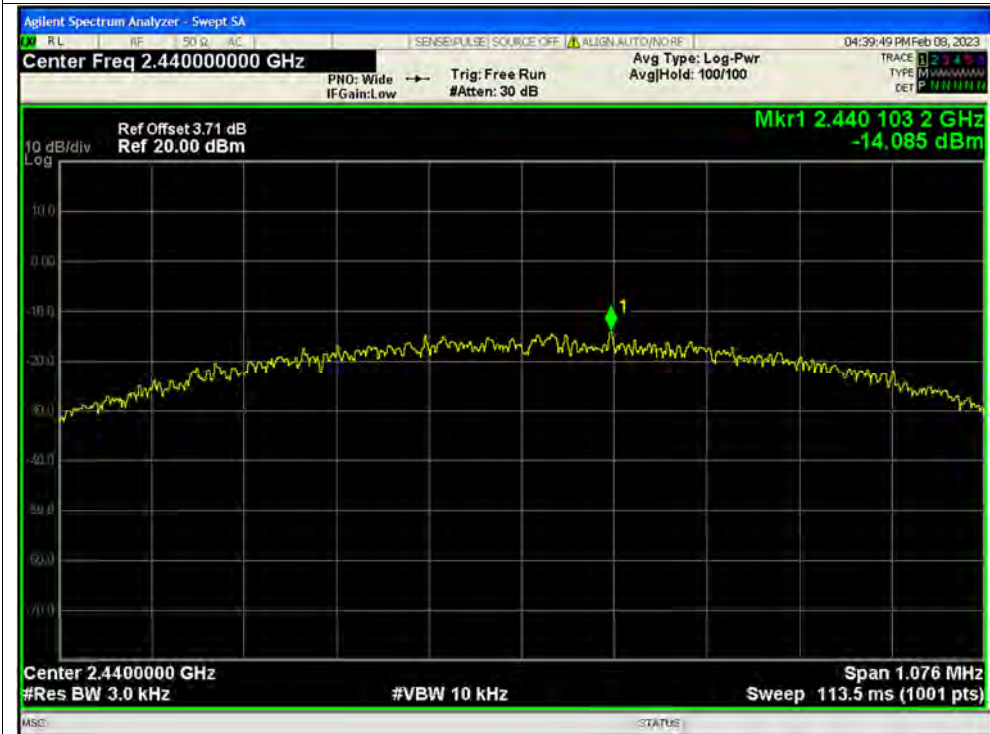
PSD NVNT BLE 1M 2440MHz Ant1
