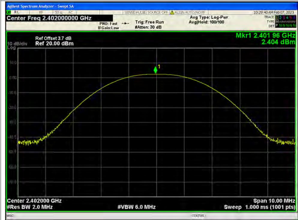
Peak Power NVNT BLE 1M 2440MHz Ant1
