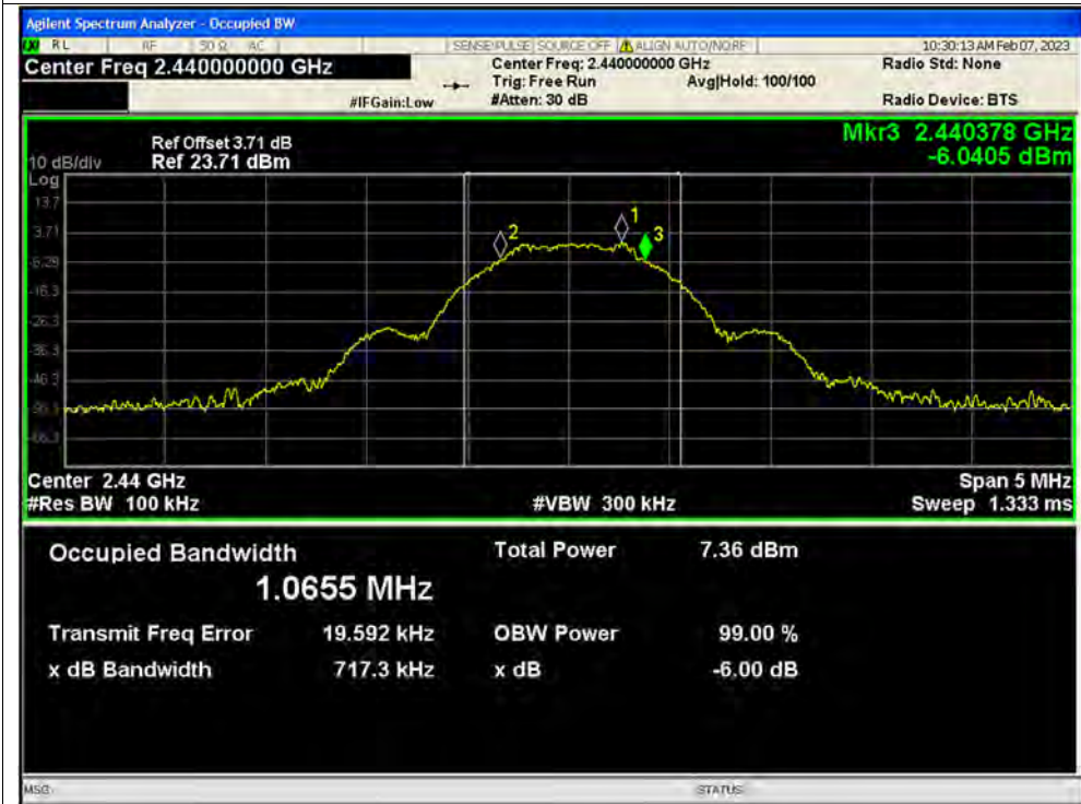
-6dB Bandwidth NVNT BLE 1M 2440MHz Ant1
