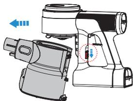
Pour nettoyer le réceptacle plus en profondeur, appuyer sur le bouton de libération du réceptacle pour le détacher complètement de l'appareil.
