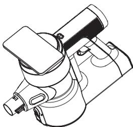
Une fois l'aimant collé, mettre le téléphone sur la zone de fixation magnétique afin de le fixer sur le corps principal.
