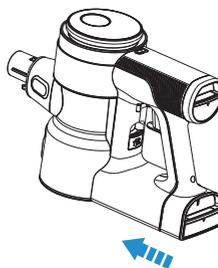
Pour remplacer la batterie, la faire glisser dans la fente située à la base du corps principal. La batterie s'enclenche en position lorsqu'elle est correctement installée.
