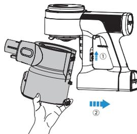
Lors de la réinstallation du réceptacle, maintenir celui-ci en angle et insérer le haut du réceptacle dans le crochet du corps principal. Pousser vers le haut jusqu'à ce que le crochet soit fixé dans la fente du réceptacle et qu'il s'enclenche en place.
