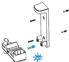
Assembler les deux composants de la station d'accueil. Un déclic se fait entendre quand l'assemblage est bon. Une fois cette opération terminée, utiliser les vis fournies par Tineco pour fixer la station d'accueil au mur.
