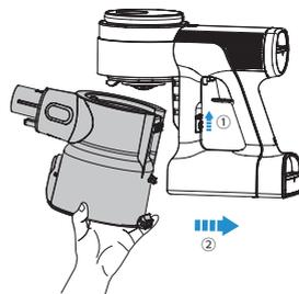
Al volver a colocar el cesto de basura, sujételo en ángulo y coloque su parte superior en el gancho del cuerpo principal. Empuje hacia arriba hasta que el gancho se fije en la ranura del cesto de basura y quede en su lugar.
