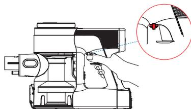
Presione el seguro del gatillo para mantenerlo en el modo de funcionamiento continuo.
