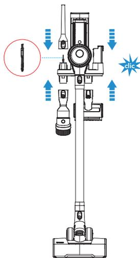
Para evitar que se dañen las cerdas, siempre coloque los accesorios en el soporte después de su uso.
