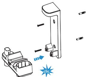
Monte los dos componentes del soporte. Escuchará un "clic", el cual le indicará que se ha montado correctamente. Una vez que haya terminado, utilice los tornillos que suministra Tineco para fijar el soporte a la pared.
