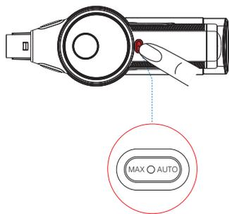
De manera predeterminada, el aparato se iniciará en el modo AUTO. Después de 3 segundos, presione el botón MAX/AUTO para cambiar al modo MAX.
