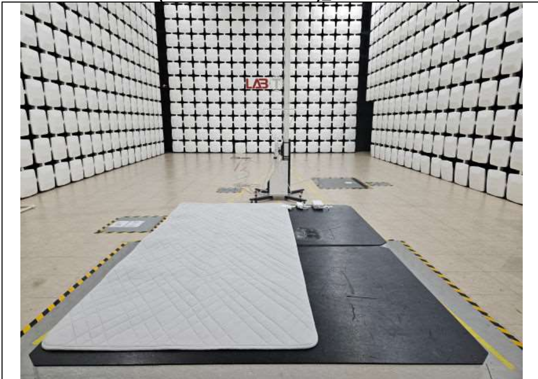
Test distance : 3 m, height of table : 0.8 m
