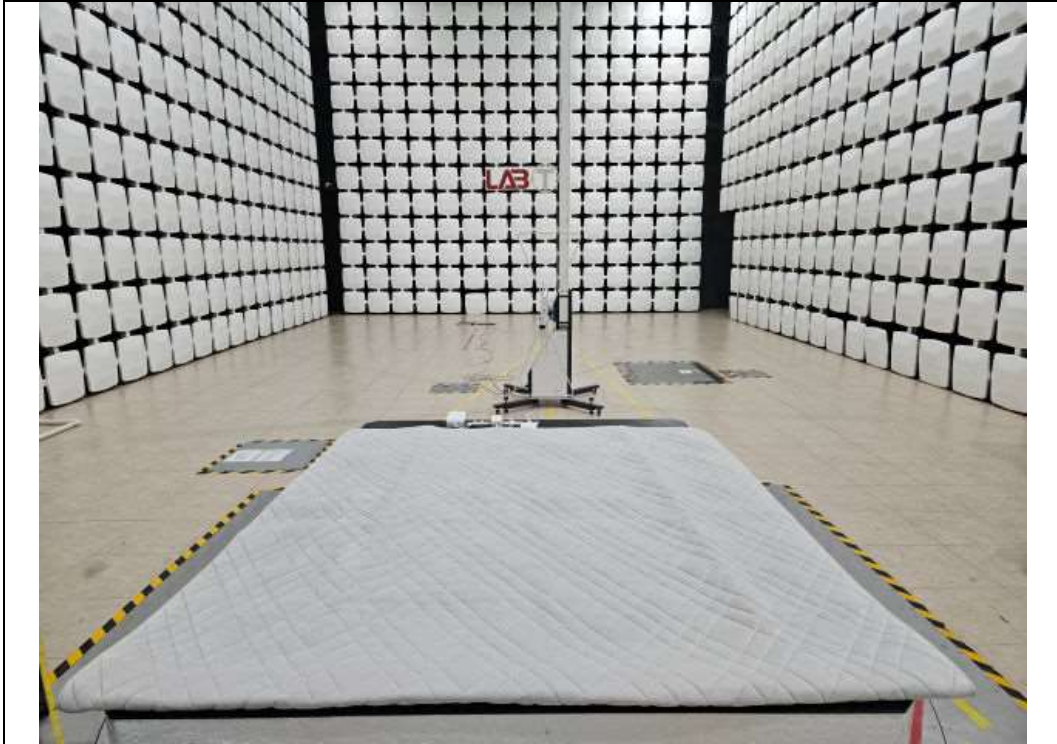
Test distance : 3 m, height of table : 0.8 m
