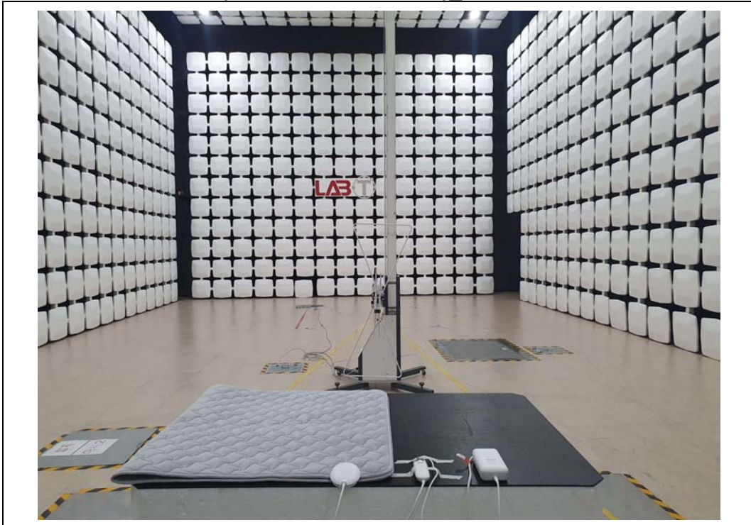
Test distance : 3 m, height of table : 0.8 m
