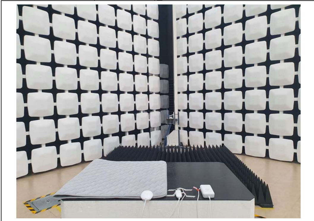
Test distance : 3 m, height of table : 0.8 m
