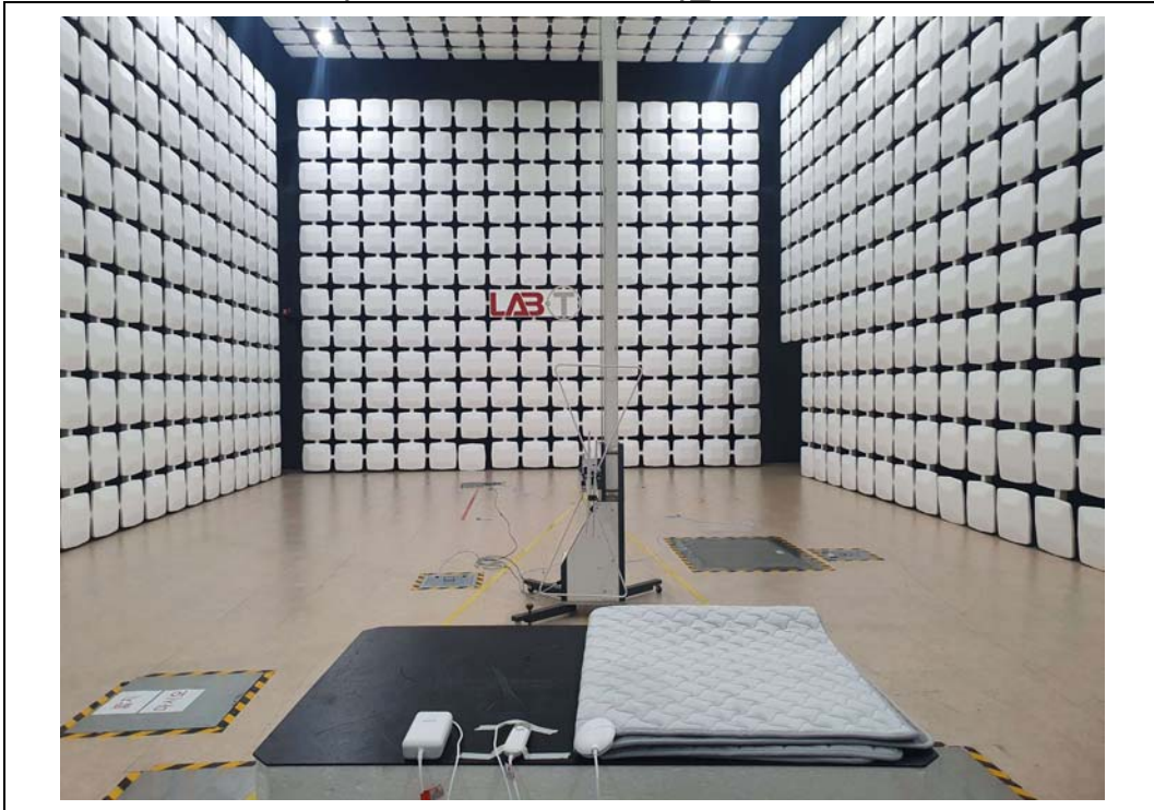
Test distance : 3 m, height of table : 0.8 m
