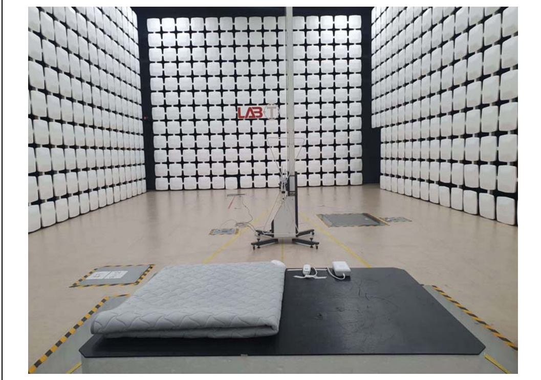
Test distance : 3 m, height of table : 0.8 m
