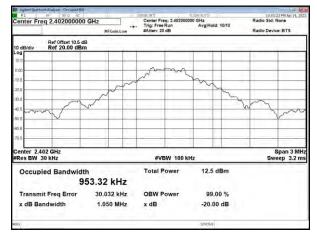
Modulation Type:  $\pi/4$ -DQPSK (2Mbps)
