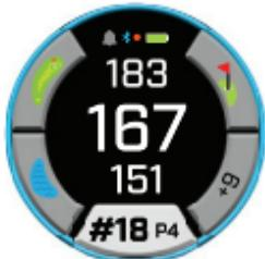
常亮 蓝色坡度环 - 表示设备已校准并显示坡度补偿距离。
