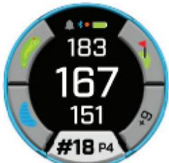
点灯した青の勾配リング - 製品が校正され、勾配が補正された距離が表示されていることを示します。
