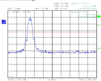
Test Mode : BLE 2480 MHz Band Edge
