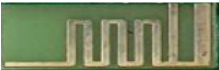
Antenna Dimension: 10 x 0.7 mm
