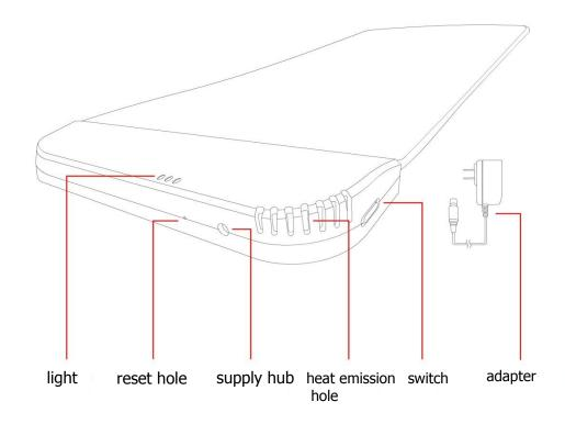
pilot light、Reset hole、Power Jack、Cooling hole、button、The power adapter
