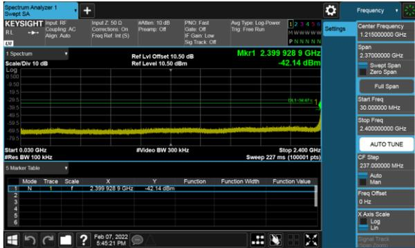
Modulation Type: GFSK(1Mbps), ANT B CH19
