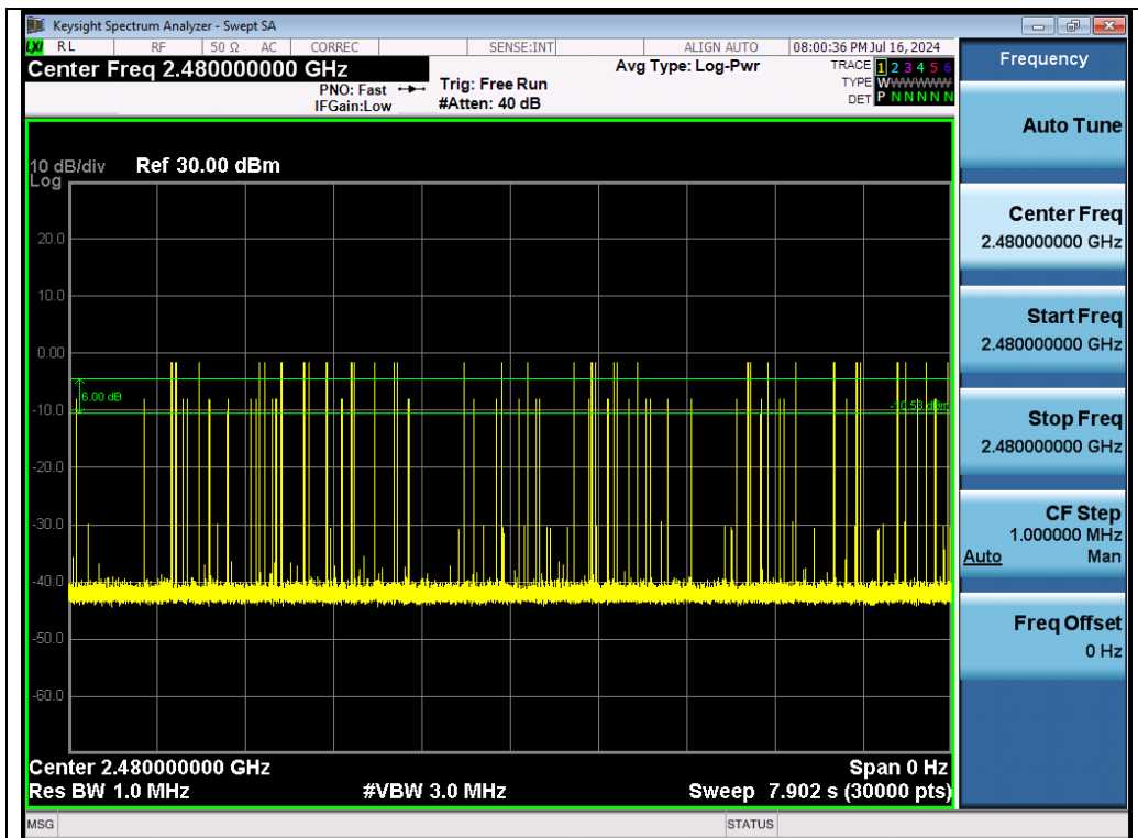
Test_Graph_EDR_HOP_ANT1_NA_3Mbps_2480_Number of Burst
