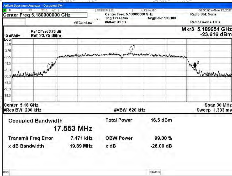
-26dB Bandwidth NVNT ac20 5200MHz Ant1
