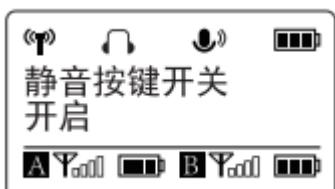
静音键设置: 开启 / 关闭静音功能 (开启为系统默认设定)
