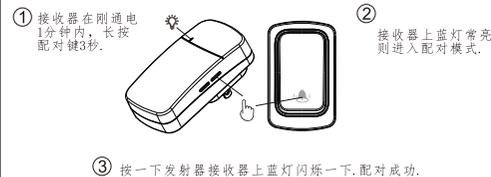
2. 清除对码：如图示接收器在刚通电1分钟内长按接收器上按键不放直到指示灯常亮后闪3下，即清除掉所有对码。
