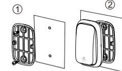
特别提示：请避免安装在金属物（铁门，铁窗等）上，以免影响发射距离。固定前请试用可行与否。
