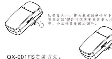
5. 音量大小：接收器在通电情况下短按“音量调节及返回”键即可依次变更音量大小，音量大、小、三种音量依次循环。
