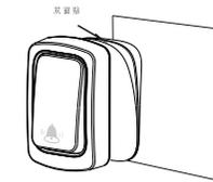
特别提示：请避免安装在金属物（铁门，铁窗等）上，以免影响发射距离。固定前请试用可行与否。
