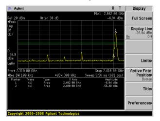
$\pi$  /4-DQPSK: Band Edge-Low Channel (Hopping Mode)
