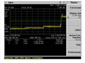
$\pi$  /4-DQPSK: Band Edge-High Channel
