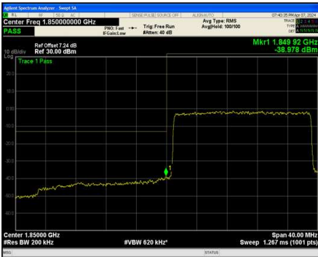
Band2 QPSK BW=20MHz Channel=19100 RB Size=100 Position=#0
