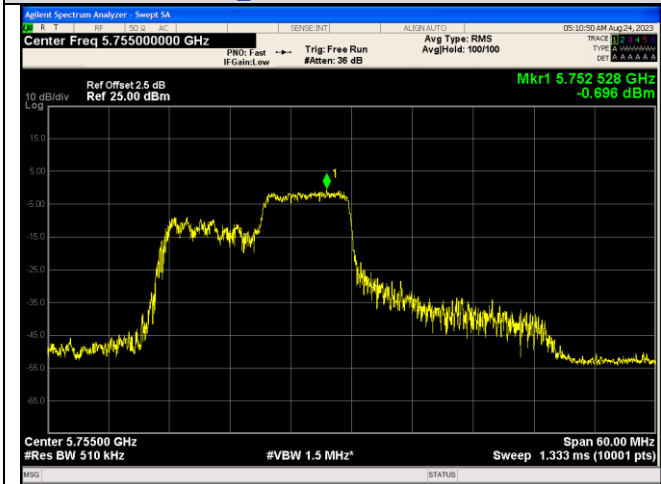
IEEE 802.11ax_Channel 151_40MHz_Antenna 0_RU&Index 106RU54
