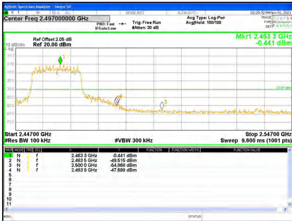
Band Edge NVNT n40 2422MHz Ant1 Ref
