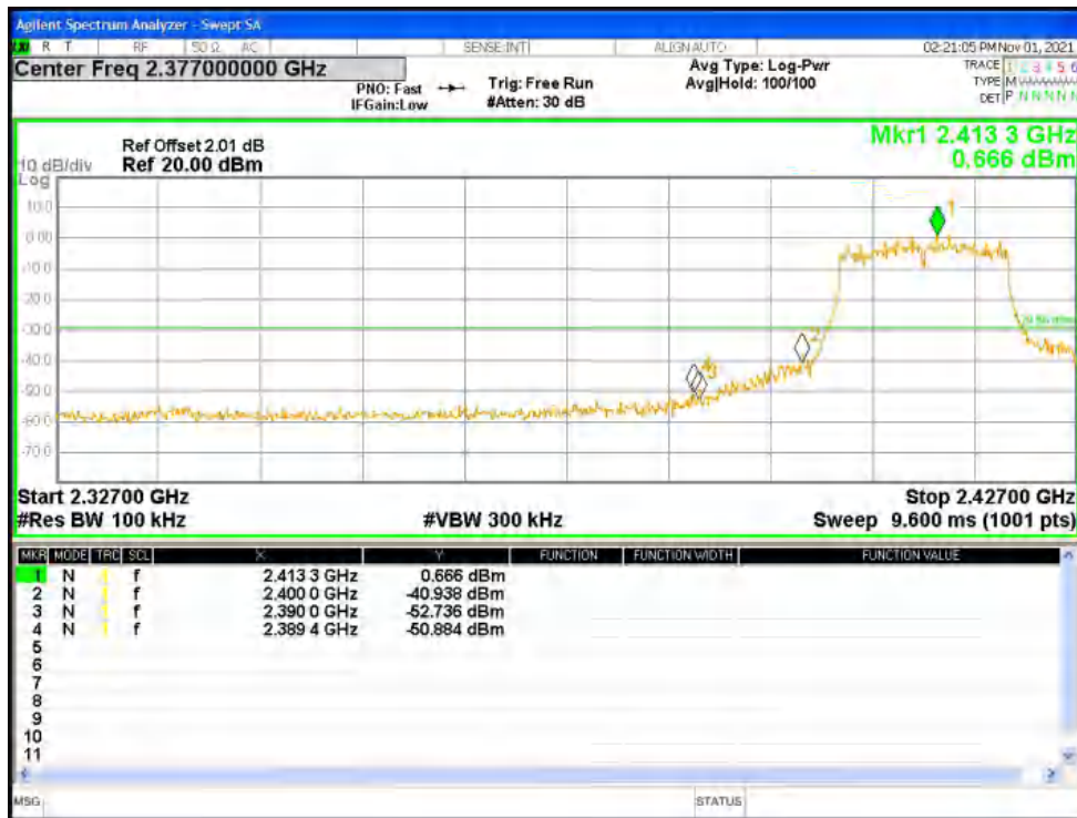
Band Edge NVNT g 2462MHz Ant1 Ref
