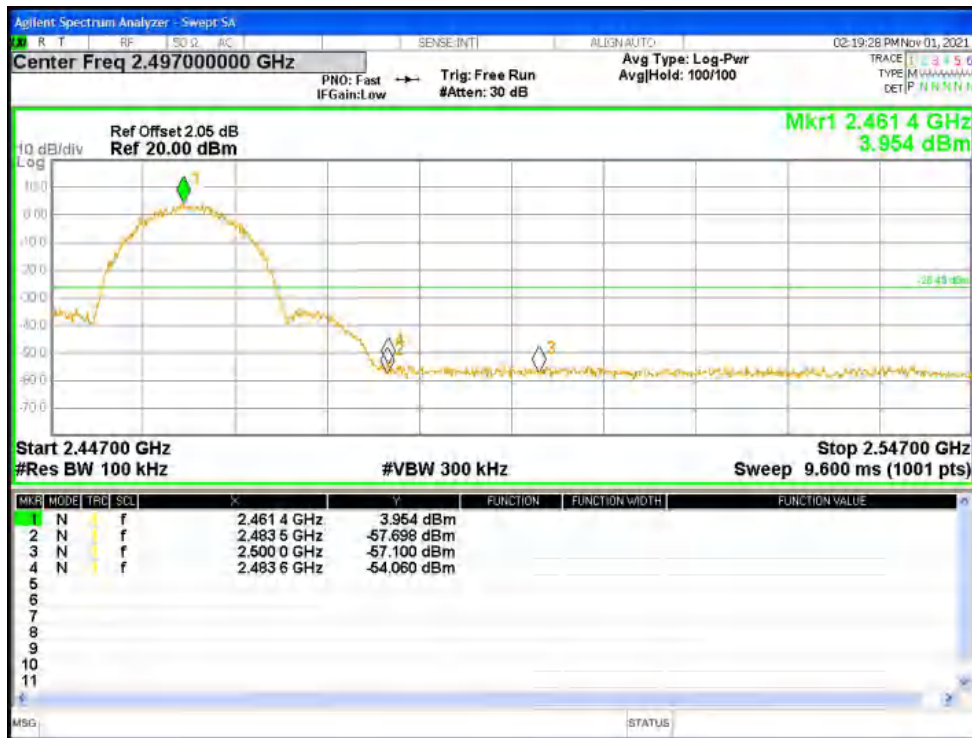
Band Edge NVNT g 2412MHz Ant1 Ref
