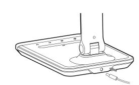
\*将电源适配器DC头插入底座后方的电源插孔内。 (注意) 内附的电源适配器为本产品专用,不能用于其它电器。
