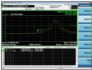
GFSK (BLE 1Mbps) HIGH CHANNEL, CARRIER LEVEL
